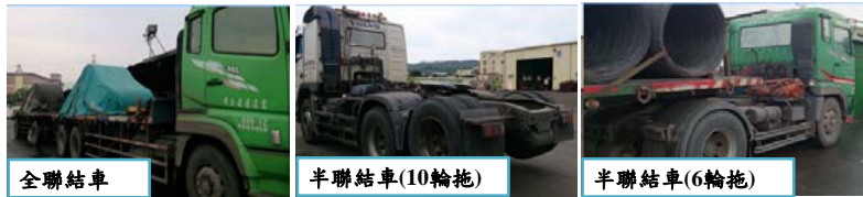
註:1.全聯結車：曳引車或汽車(母車)與一輛全拖車(子車)組成之車輛。 2.半聯結車：曳引車後聯結一半拖車(板車)而成之車輛。 3.曳引車(車頭)：專供牽引其他車輛之汽車。
